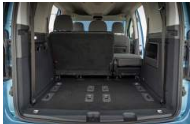
Złożone tylne oparcie w części foteli w 2. rzędzie i wymontowane fotele 3. rzędu
